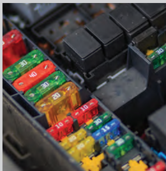
Kontrola automobilových pojistek – barva a materiál
