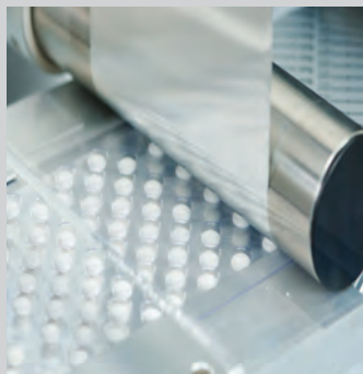
Kontrola lesklých blistrových balení
