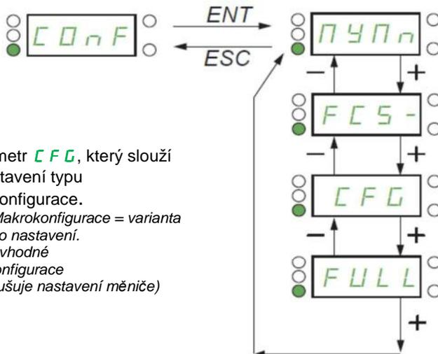
3. Parametr **C F G**, který slouží pro nastavení typu makrokonfigurace.
