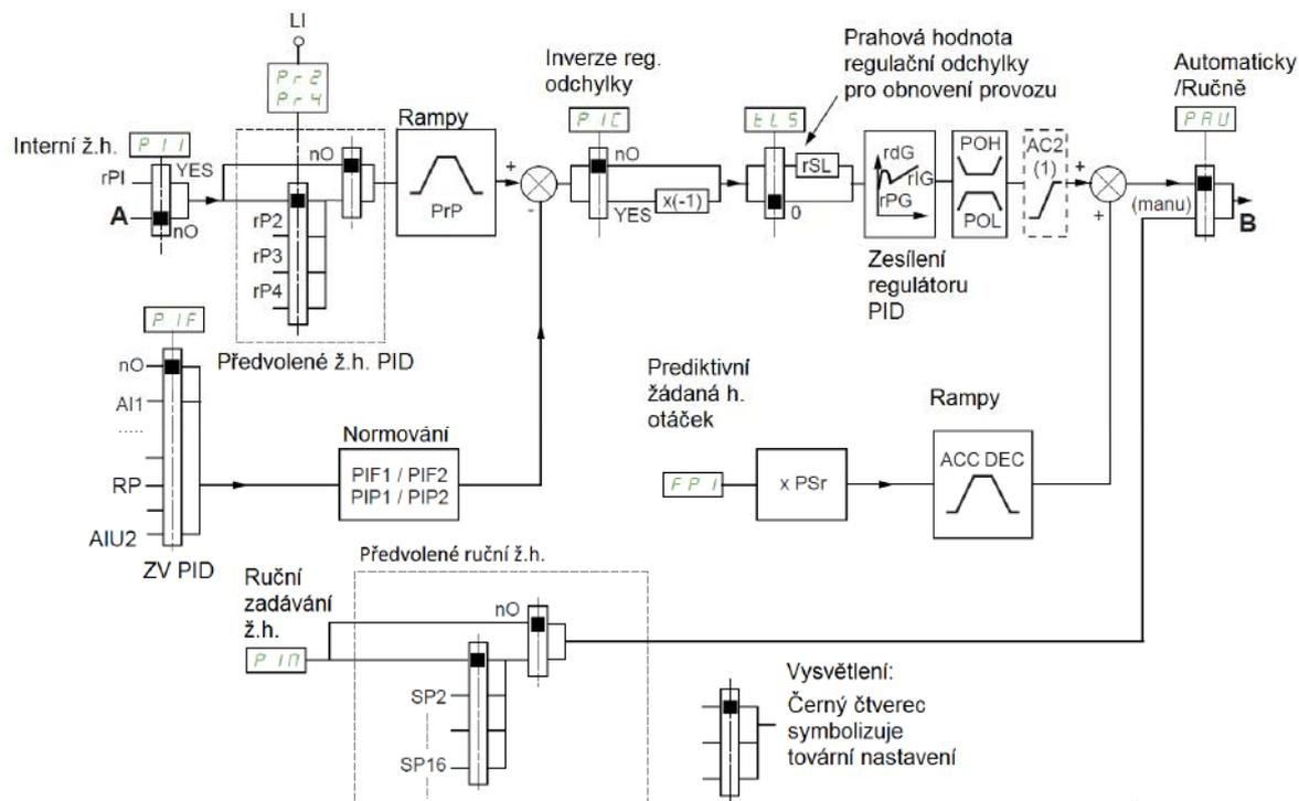
(1) Rampa **PrP** je aktivní pouze v případě startu, nebo obnovení provozu PID regulátoru po odstavení.
