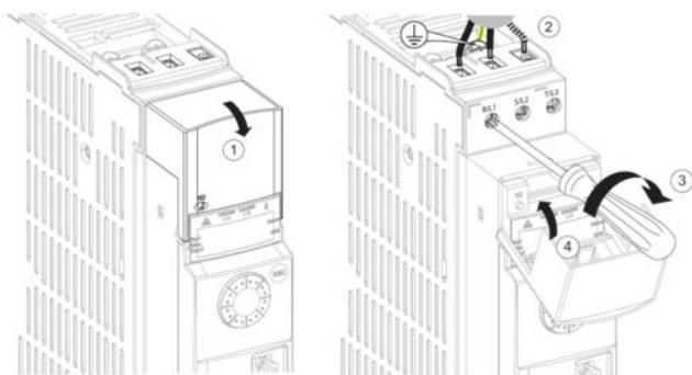
Společná násuvná svorkovnice pro připojení motoru a brzdového rezistoru se nachází ve spodní části frekvenčního měniče. Pro typové velikosti frekvenčních měničů 1B a 2B tvoří svorkovnice jeden celek s EMC deskou pro připojení stínění kabelů.
