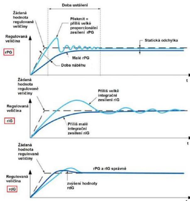
Frekvence oscilací záleží na kinematice regulované soustavy:
