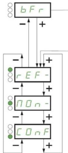
Parametry jsou rozděleny do tří skupin (menu) pro každý pracovní režim frekvenčního měniče: Režim zadávání žádané hodnoty **rEF**, monitorování provozních parametrů **POn** - a konfigurace a nastavení frekvenčního měniče **COnF**. Přepínání mezi výše popsanými režimy je možné prostřednictvím otáčení a potvrzení stiskem (**ENT**) navigačního točítka obslužného terminálu.
